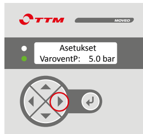
1.9 Paina ► muuttaaksesi varoventtiin avautumispainetta "VaroventP".
